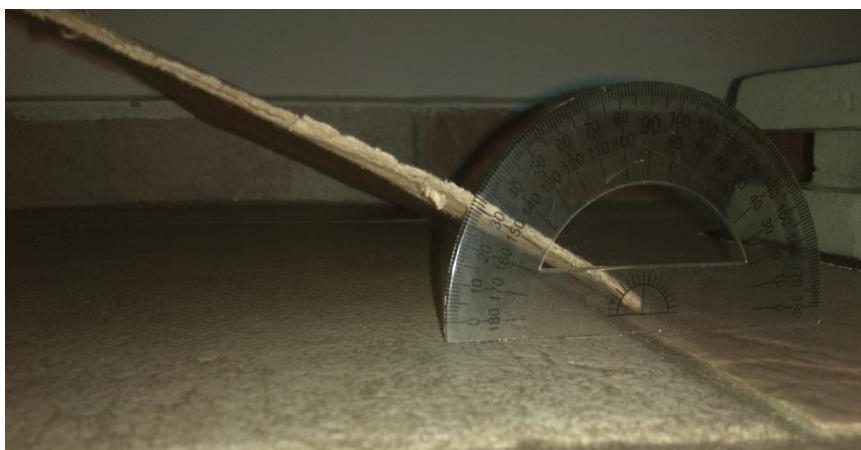
Εικόνα 5.2. Τοποθέτηση χαρτονιού με τη χρήση μοιρογνωμονίου
