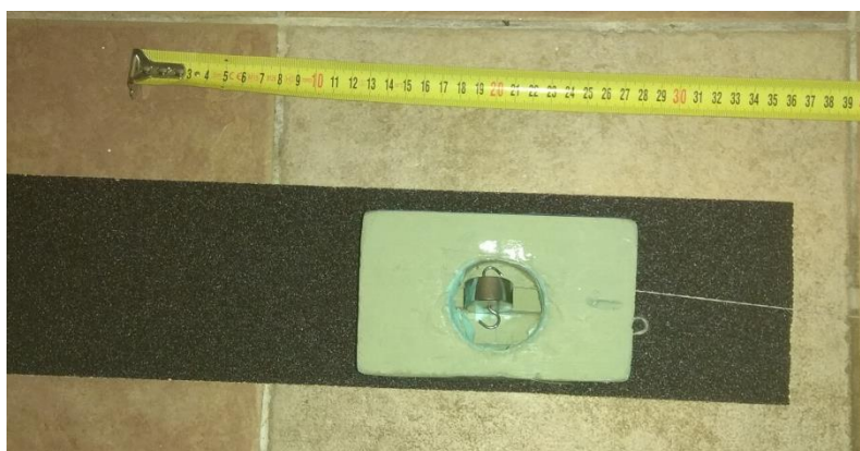
Εικόνα 5.18. Αποτέλεσμα τραβήγματος φορτίου 50 γραμμαρίων στο μαύρο γυαλόχαρτο
