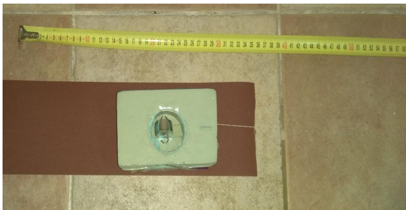
Εικόνα 5.17. Αποτέλεσμα τραβήγματος φορτίου 50 γραμμαρίων στο κόκκινο γυαλόχαρτο
