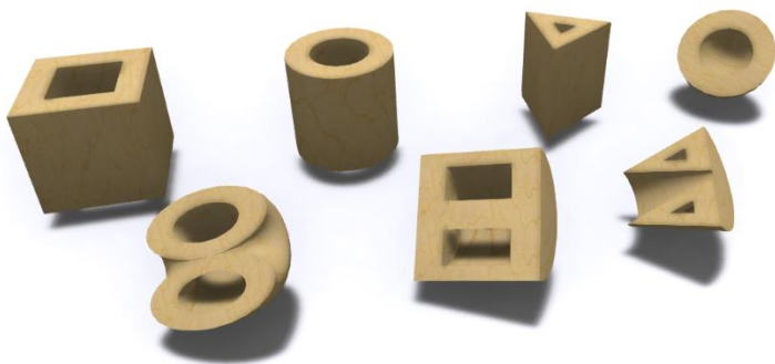
Εικόνα 8.8 Δημιουργία οπής σε βασικά στερεά. Στα τελευταία τέσσερα έχει γίνει και αποκοπή μονοπατιού για να φανεί το εσωτερικό τους.
